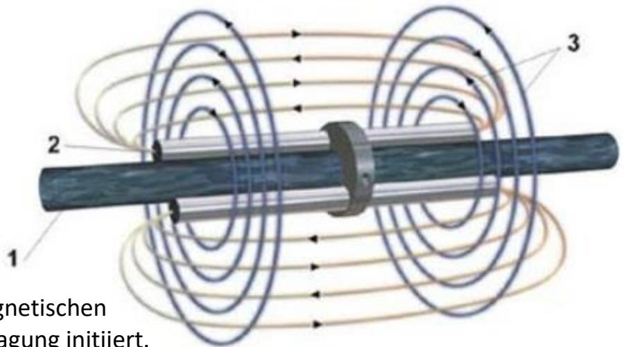
Mittels schwachem elektromagnetischen Feld wird eine Resonanzübertragung initiiert.
